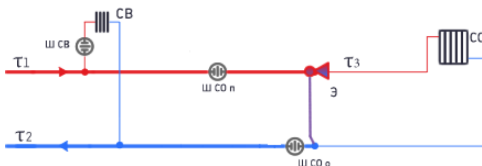
Рисунок 11 – Схема подключения потребителей к двухтрубной тепловой сети (при наличии внутридомовой системы отопления), в качестве регулятора температуры используется элеватор (СО – система отопления, Э – элеватор, СВ – система вентиляции)
